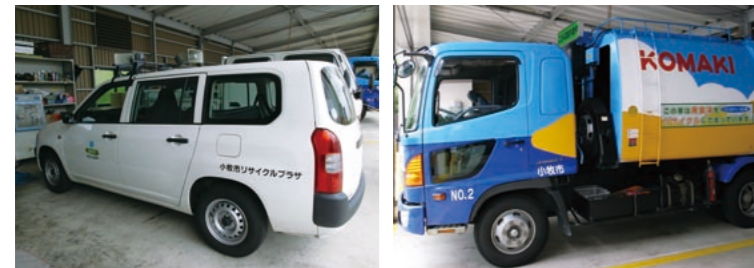
写真左はCNG(圧縮天然ガス)車のバン、右はバイオディーゼルエンジン搭載のゴミ収集車
