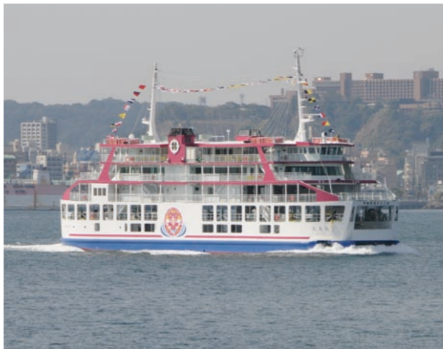
桜島フェリー初の電気推進船でスーパーエコシップの新船「サクラエンジェル」(3月10日就航予定)
