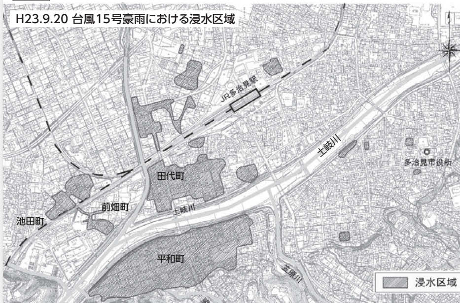
図1 市内を流れる土岐川と平成23年9月豪雨における浸水区域
