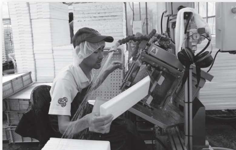
働く人に合わせて開発されたオリジナルの半自動トレー洗い機
