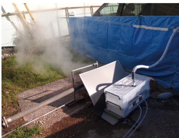
温泉蒸気を活用した「湯けむり発電」の実証実験
