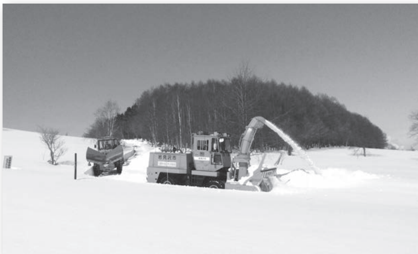
農業用GPSガイダンスを活用した除雪作業
