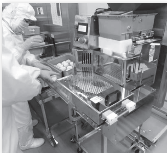
1時間3000個の製造能力を持つ「おにぎり製造機」
